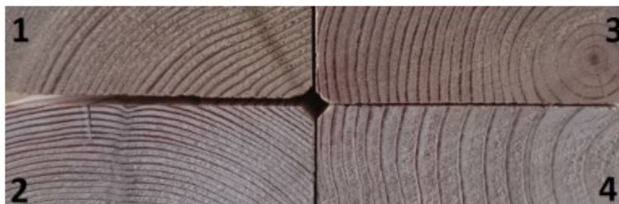
1. Halbriftbrett/2. Fladerbrett/3. Riftbrett (enge Jahresringe)/4. Riftbrett (weite Jahresringe)
